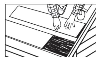
Paso 4 – Utilice el cíter para cortar la sección final en el largo adecuado. El conector integrado final de la sección final debe conectarse con la terminación del techo. Sujete la sección final.
