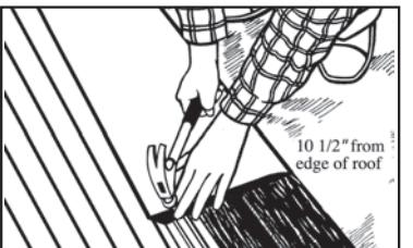
Paso 3 – Verifique que la ranura esté abierta como en el Paso 2 e instale el Intake Vent sobre esta. Asegúrese de que el borde inferior del conector final termine en el límite del techo. Colocar topes en la cara inferior del Intake Vent puede ayudar a posicionarlo sobre la ranura. Utilice orificios para clavos para sujetar la ventilación en su lugar.
