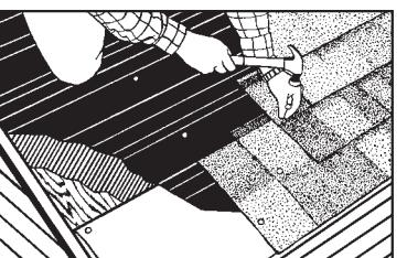
Étape 6 – Installer les bardeaux de la rangée de départ et de la première rangée sur le feutre/la sous-couche d'étanchéisation des bardeaux WinterGuard™ recouvrant la prise d'air Intake Vent suivant les directives du fabricant des bardeaux en ce qui a trait au surplomb et au clouage des bardeaux. Le patron du clouage peut devoir dévier des instructions pour l'installation des bardeaux pour éviter de clourer à l'emplacement de la fente.
