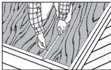
Étape 1 – Retirer tous les matériaux de toiture dans les applications de réfection du toit. Installer le solin d'avant-toit et les attaches de gouttière au besoin. Mesurer 127 mm (5 po) à partir du pli du solin d'avant-toit pour marquer la ligne inférieure de la fente. Mesurer 19 mm (3/4 po) plus haut pour marquer la ligne supérieure de la fente.
