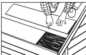
Étape 4 – Utiliser un couteau à lame rétractable pour couper la section finale à la bonne longueur. Le bouchon d'extrémité intégré de la section finale devrait être dans l'alignement de l'extrémité du toit. Fixer la dernière section.
