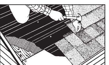
Paso 6 – Coloque la hilada inicial y la primera hilada de tejas sobre el fieltro o la capa de impermeabilización con WinterGuard™ para tejas cubierta con Intake Vent siguiendo las instrucciones del fabricante de las tejas para ver cuánto deben sobresalir y cómo deben colocarse los clavos. Es posible que el patrón de colocación de clavos deba apartarse de las instrucciones de instalación de tejas para evitar clavar donde se encuentra una ranura.
